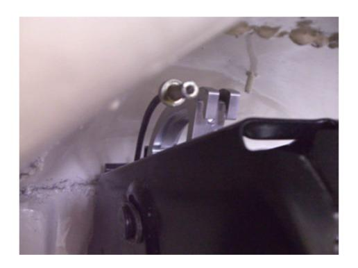
2). Remove brake actuator clip on front of the brake pedal.
